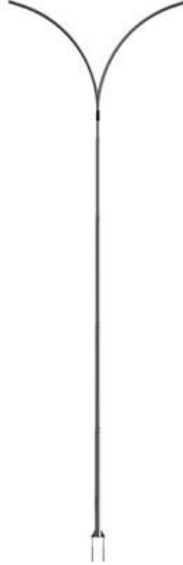
Modelo de Poste cônico contínuo curvo duplo.
